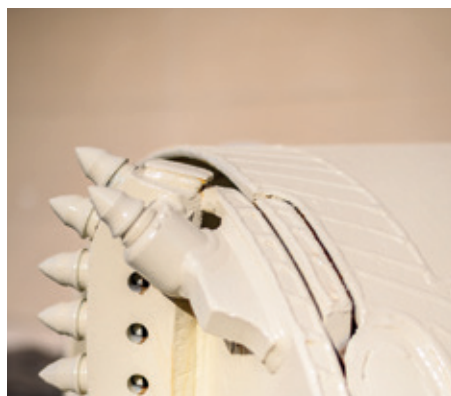
Ковш-бур с наплавкой твердосплавной проволокой. Bucket with hard facing
