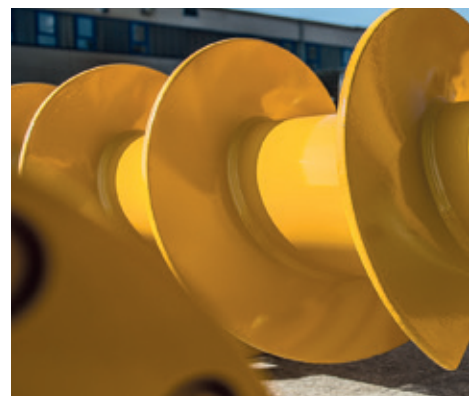
Витки шнекового бура с наплавкой твердосплавной проволокой. Auger flights with hard facing
