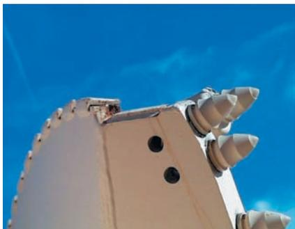
Зубец круглого сечения применяется в качестве секущего зубца в шнековых, ковшбурах и колонковых бурах. Среди режущих зубьев различают несколько типов, позволяющих перекрывать различные потребности.
