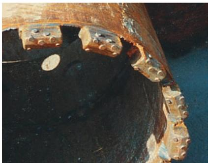
Нарезные кольца обсадных труб или колонковые буры оснащены приварными резцами. Возможность выбора резцов позволяет пробуривать любые грунты и бетон (при изготовлении свайных стен).
