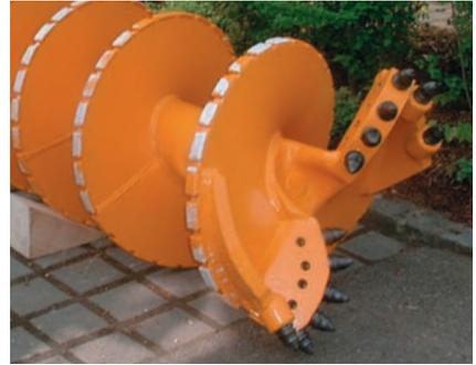
**Износозащитный уголок Verschleißwinkel**
