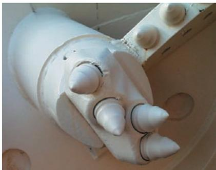
Пилоты предназначены для разрыхления грунта кончиком бура, а также направления и центровки бурового инструмента (шнекбур, ковш-бур). Они крепятся в гнезде пилота с помощью вставного штифта и могут быть заменены при помощи обычного инструмента.
